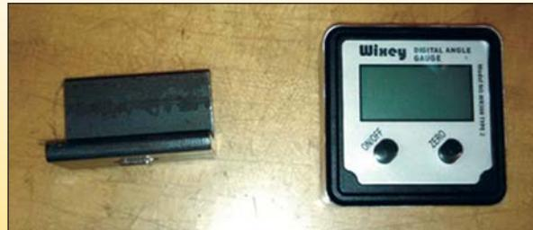
Рис. 1. Подставка для угломера (слева) и цифровой угломер (справа)
