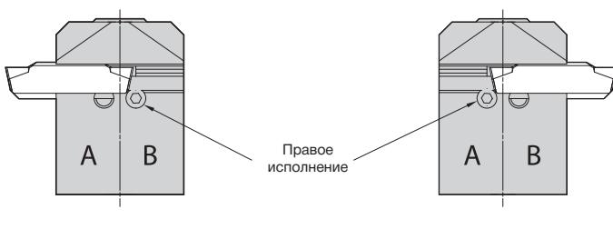
Державки A4EN могут использоваться с пластинами в правом или левом исполнении. Посадочный винт должен использоваться в положении B для пластин левого исполнения и в положении A для пластин правого исполнения.
