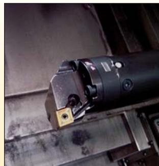
Рис. 3. Лыска на кольце расточной оправки
