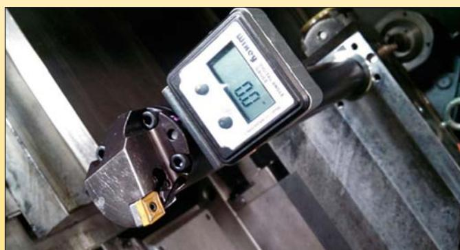
Рис. 4. Центрирование расточной оправки
