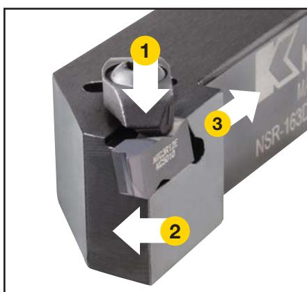
Жесткая конструкция прижима препятствует смещению пластины при обработке на больших подачах. Это преимущество обеспечивает высокое качество обработанной поверхности, повышенную производительность и превосходный ресурс стойкости инструмента. Жесткий прижим создает прижимающие усилия в трех направлениях для обеспечения превосходного сопротивления воздействию боковых и тангенциальных сил.
